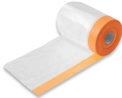
Ausfaltbar, HDPE-Folie mit faserverstärktem Papierklebeband in Orange am Rand, für scharfe Kanten auf robusten und anspruchsvollen Untergründen. Temperaturbeständig bis zu 100 °C (20 Min.).
